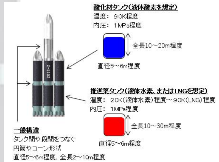
図1 想定する大型構造材の例
