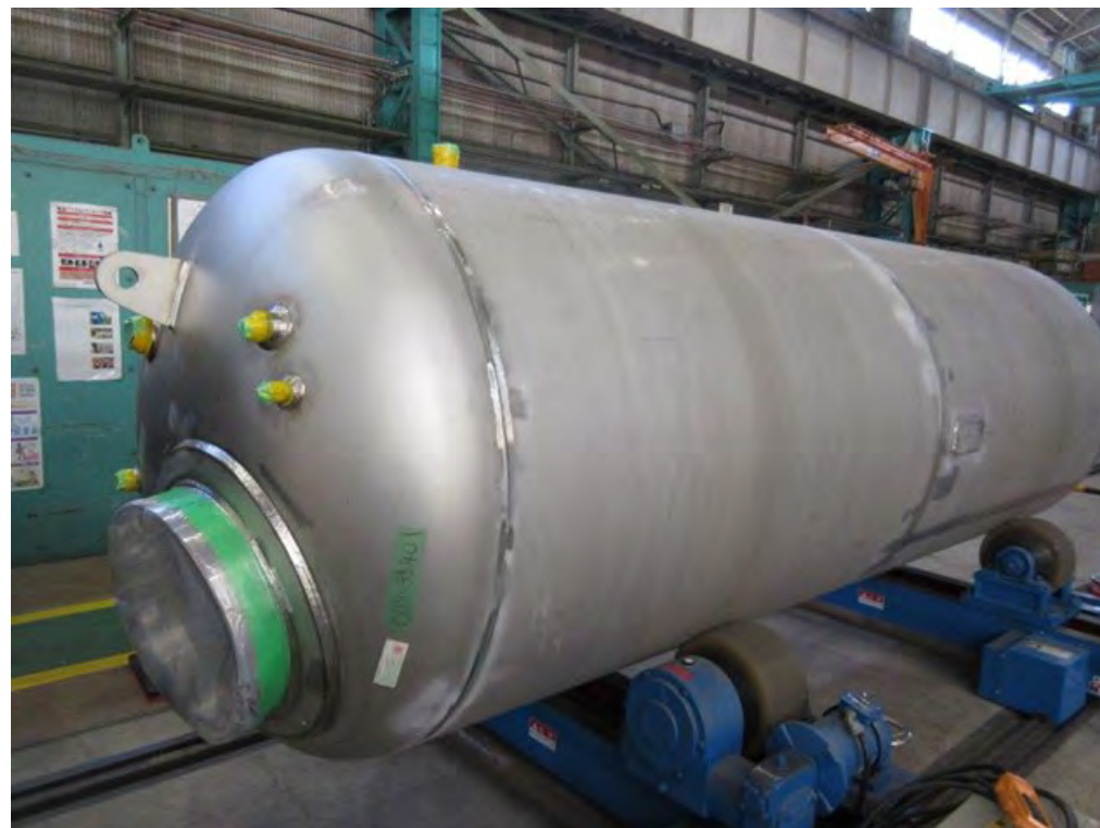
5m 3 低圧ランタンク内槽
