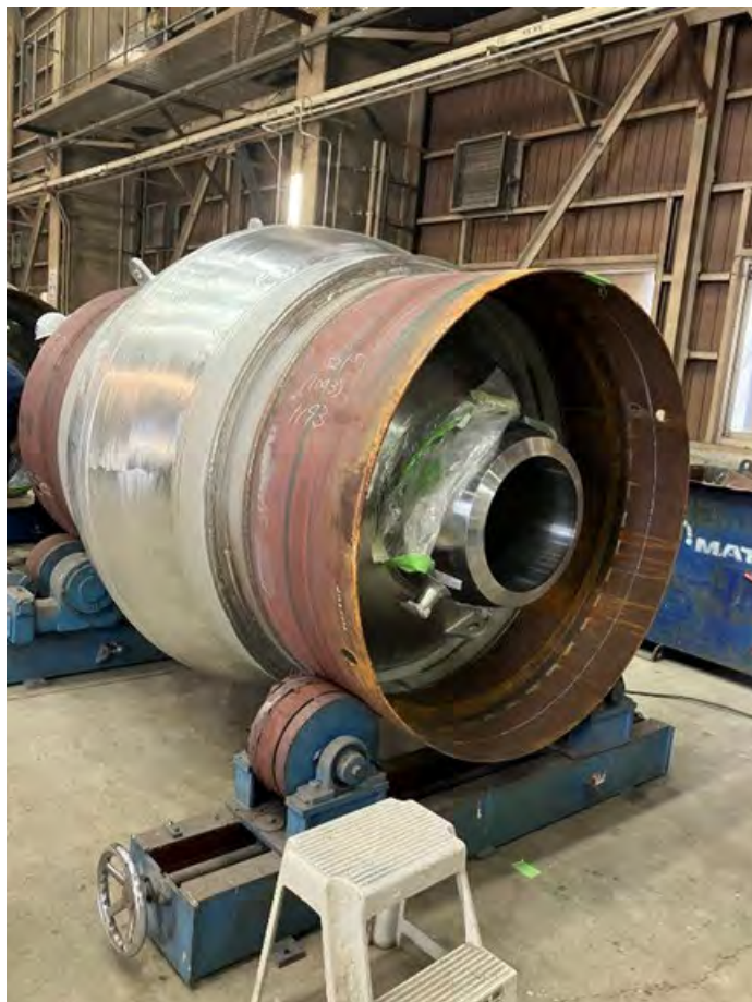
肉厚95mmの推進剤2m 3 高圧ランタンク内槽
