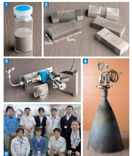
1 3Dプリンタで製造する際の素材となる金属パウダー 2メッシュ構造の試作 3 4スラスタに使用されている噴射器やノズルへの適用を目指す 5 3Dプリンタによる部品製造実用化に向けて研究を行っているスタッフ。後列左より、草間光治(AES)、長田泰一、畑井啓吾、増田井出夫、藤井 剛。前列左より、池田博英、香河英史、升岡 正、毛利和生
